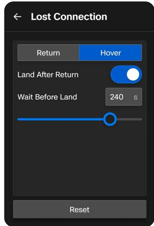
Skydio X10D continuará flotando mientras intenta recuperar la conexión. Si no se vuelve a conectar y llega a un punto de batería baja:
