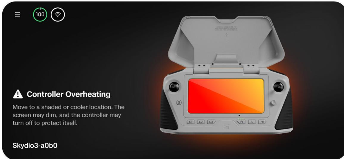
Para mitigar el sobrecalentamiento y reducir el riesgo de pérdida de conexión durante el vuelo, el controlador emitirá dos alertas y brindará orientación al operador.
