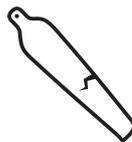
飛行前にプロペラ翼が損傷していないか確認してください。
