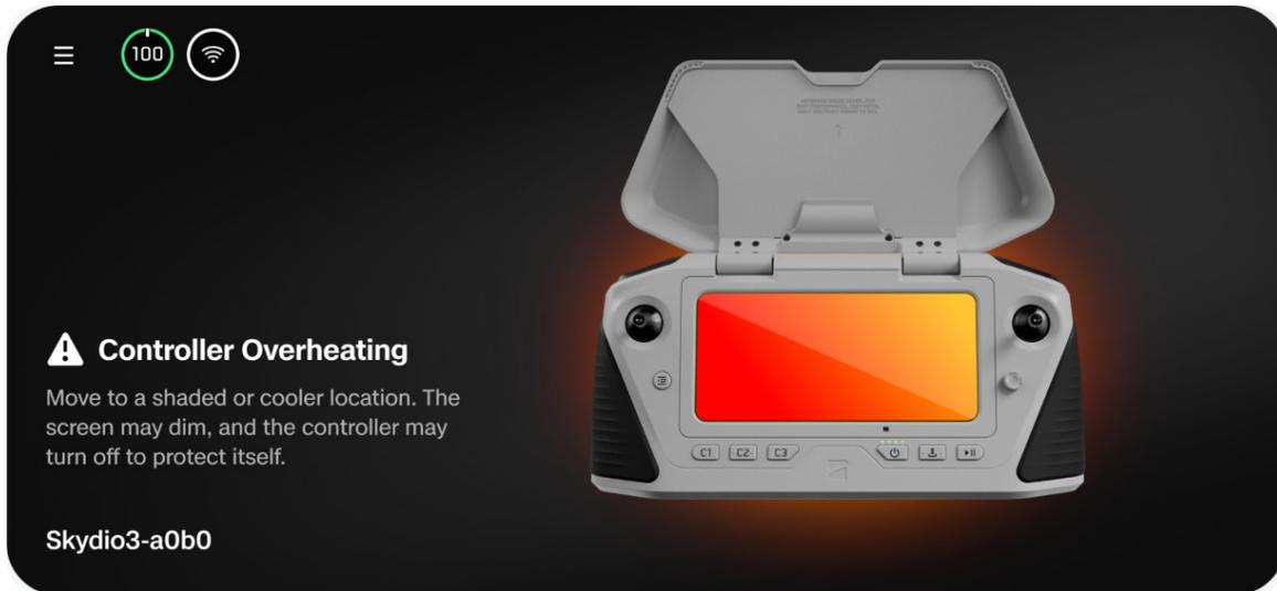
Pour éviter toute surchauffe et réduire le risque de perte de connexion pendant le vol, le contrôleur émettra deux alertes et fournira des conseils à l'opérateur.
