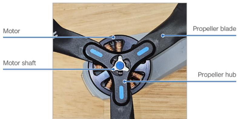
**Paso 3:** aplique una torsión opuesta firme entre el eje de las hélices y el motor en ambas direcciones sin presionar hacia abajo.
