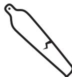
飛行前には必ずプロペラ翼に損傷がないか確認してください。
