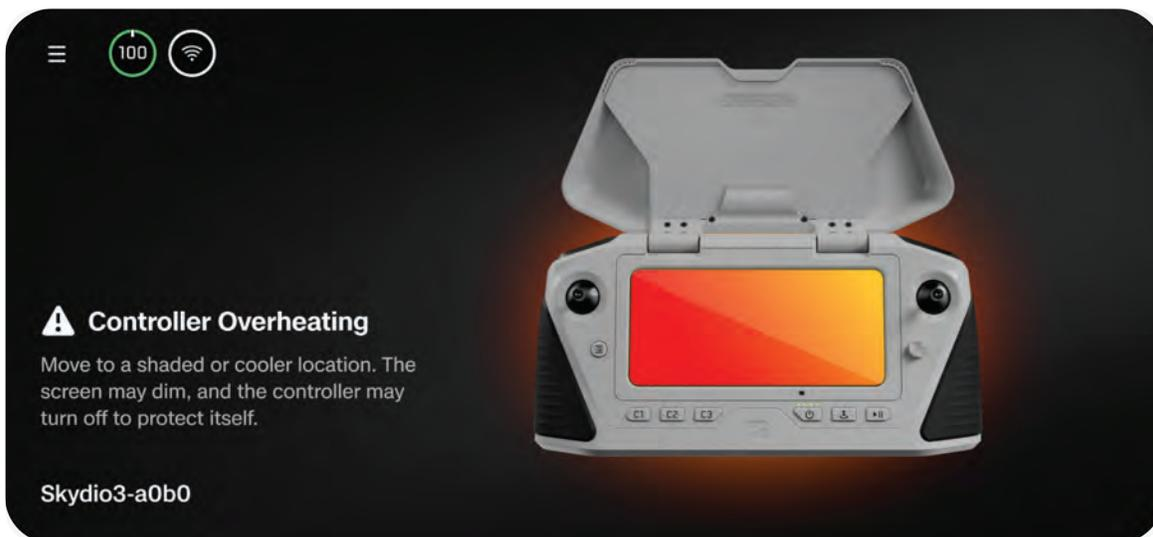
過熱を緩和し、飛行中に接続が失われるリスクを軽減するため、コントローラーは2つのアラートを発し、操縦者にガイダンスを提供します。
